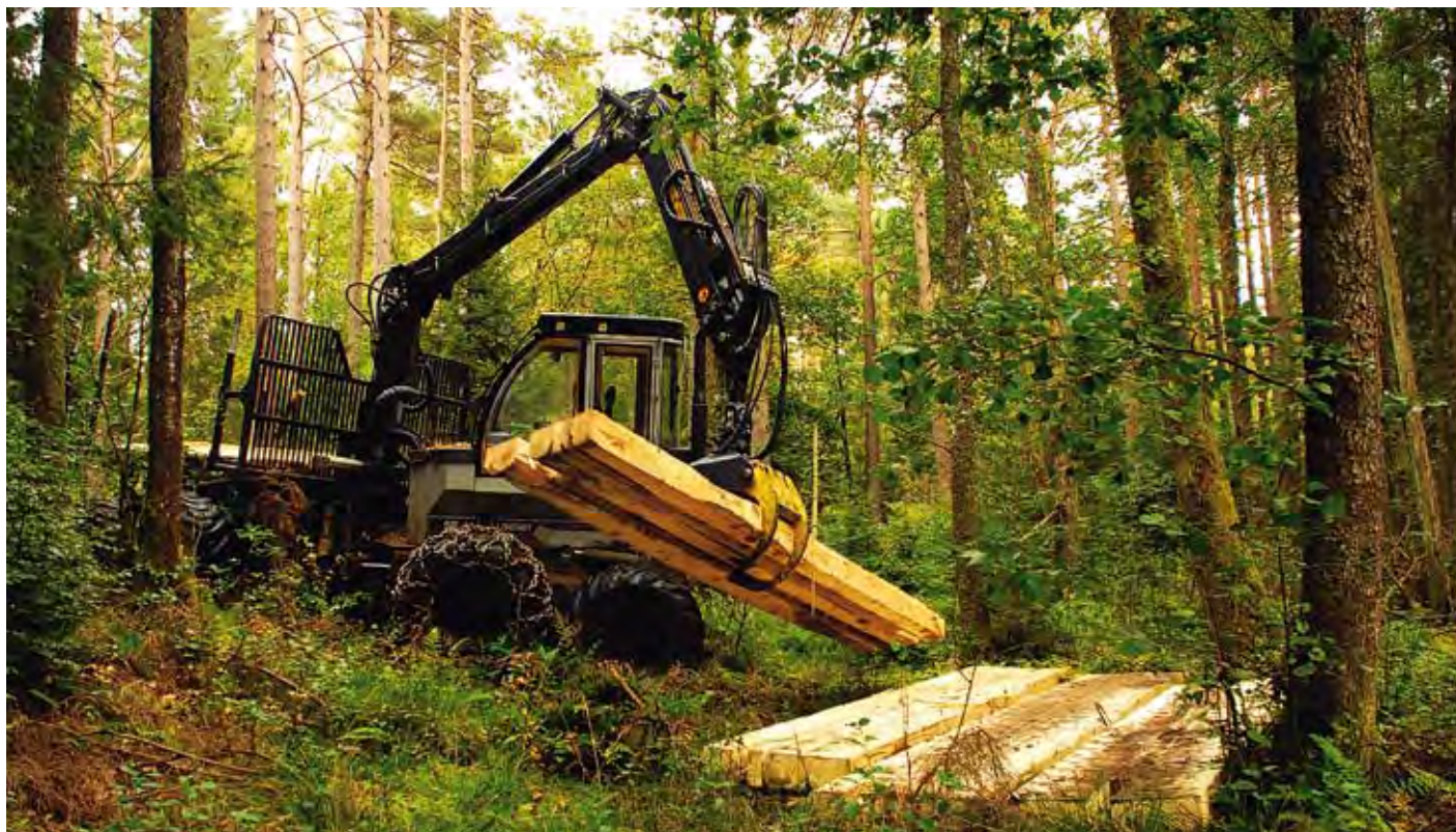
Figur 44. Träkonstruktioner ("grävmaskinsmattor") kan läggas på känsliga marker eller användas som bro för att förhindra markskador med påföljande erosion. Kostnad för en matta är cirka 1 500–2 000 kr. Foto: Lennart Henrikson
