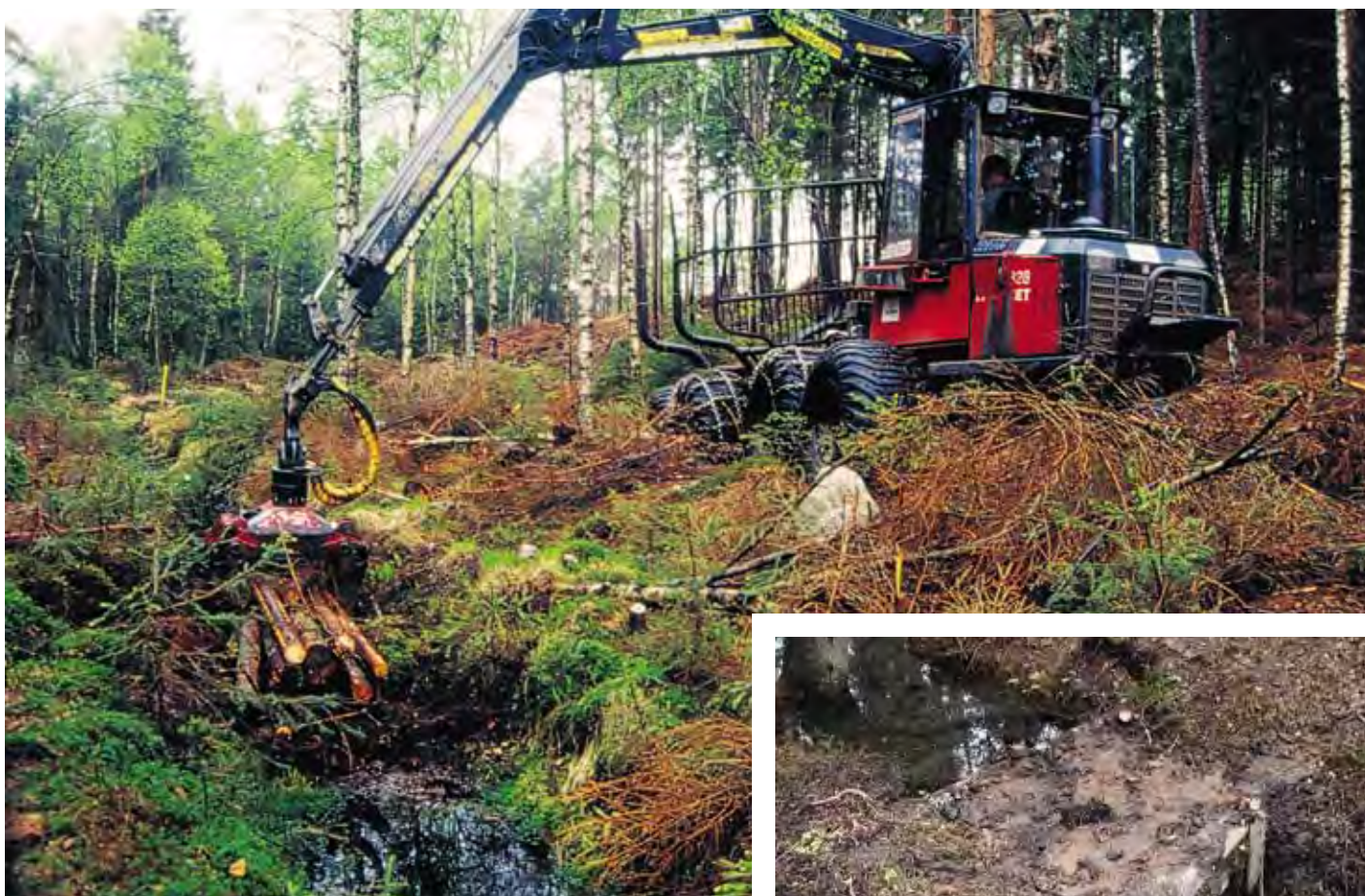
Figur 34. I WWFs och Sveaskogs demonstrationsprojektet Gallåsen, Västra Götaland, har 2,2 kilometer diken dämmts manuellt eller med grävmaskin eller skotare (bilden). Detta resulterade i 5 hektar skogliga våtmarker och förbättrad vattenkvalitet nedströms. Foto: Per Peterson
